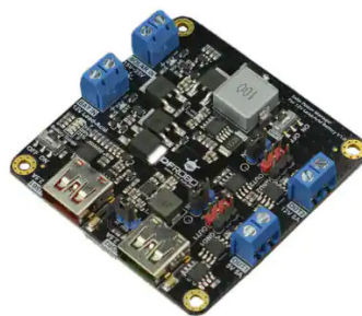
Figura 3.13.: Módulo de gestão de energia solar DFRobot DFR0580.
