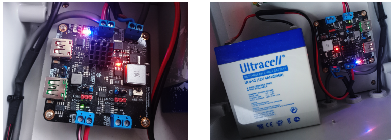
Figura C.1.: Detalhe do módulo de gestão de energia e da bateria.
