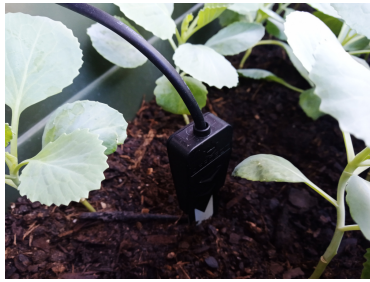
Figura C.3.: Detalhes do módulo de sensorização da humidade do solo e painel solar.
