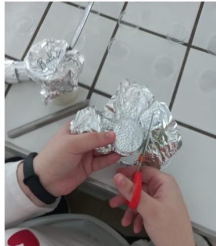
Figura 3. Recorte do excesso de papel alumínio da caixa da amostra
