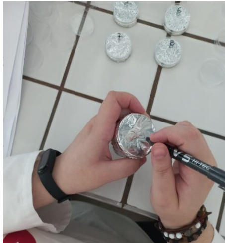
Figura 4. Realização de furos no papel alumínio para a libertação dos odores
