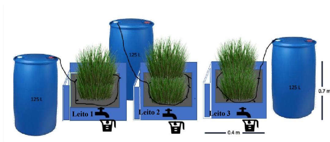
Figura 5 : Esquema da instalação piloto, com o efluente de entrada e saída (leitos 1 e 2 alimentados com caféina e o 3 como branco).
