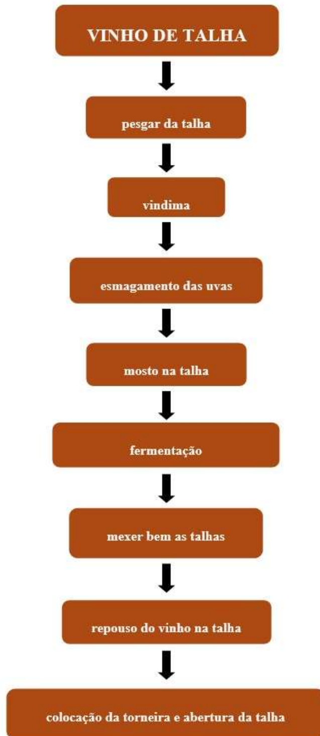
Figura 4-5- Fluxograma de vinificação do vinho de talha (Figura da autora)
