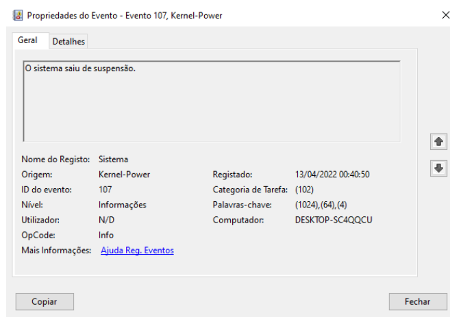
Figura 2.21: Exemplo de uma entrada de log referente a um evento de Sistema num Sistema Operativo Windows.
