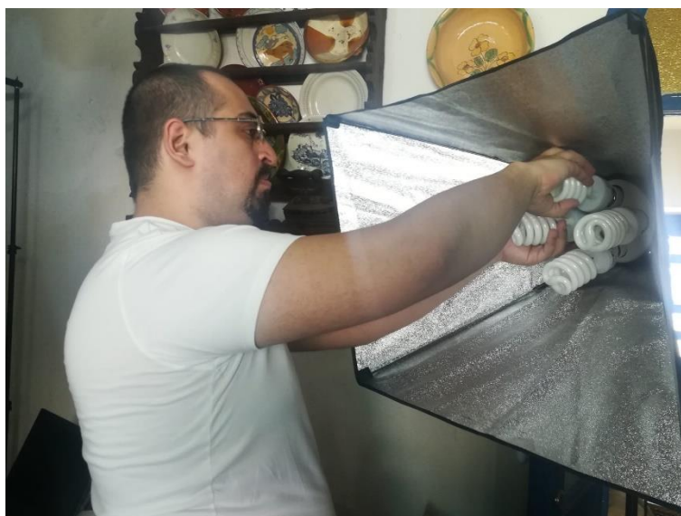
Figura 31 - Montagem das quatro lâmpadas fluorescentes da softbox.
