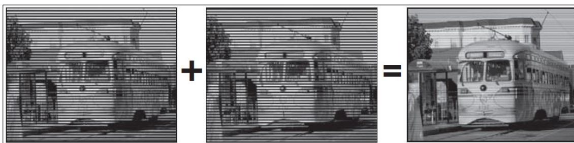
Figura 80 - Scan de pares interlaçados, passagem de linhas ímpares, linhas pares e resultado da imagem completa – extraído de “The Digital Filmmaking Handbook” (Ben Long e Sonja Schenk, 2006)
