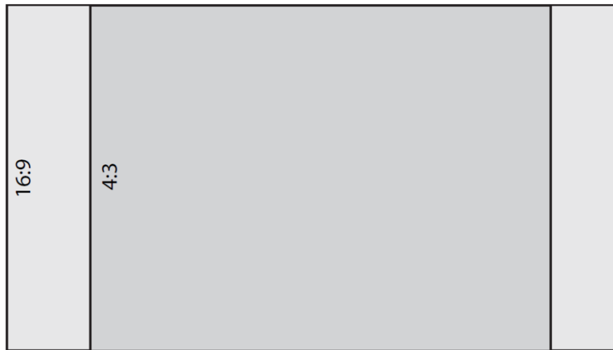
Figura 82 - O retângulo maior possui um aspect ratio de 16:9 e o retângulo mais pequeno possui um aspect ratio de 4:3 – extraído de “ The Digital Filmmaking Handbook ” (Ben Long e Sonja Schenk, 2006)
