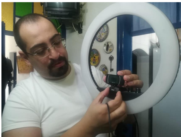
Figura 32 - Montagem da webcam na Halo Ring.
