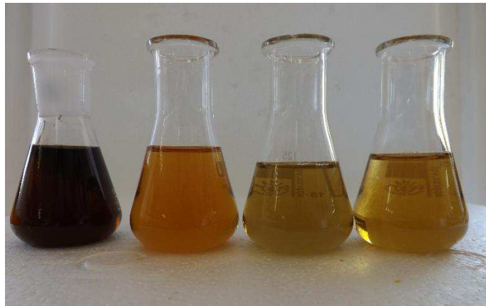
Figura 20: Efluente bruto (A) e efluente tratado proveniente da produção de azeite após precipitação química ácida com ácido nítrico a pH 1 (B), pH 2 (C) e pH 3 (D)
