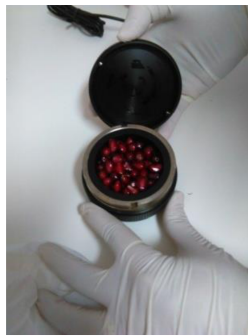
Figura 15- Determinação da cor para materiais granulares
