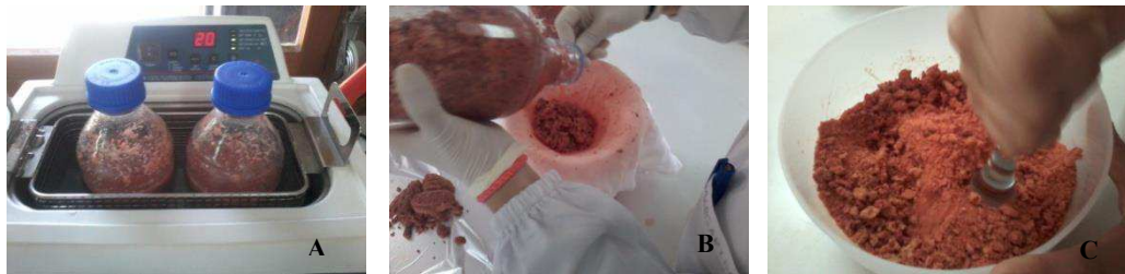
Figura 5-Preparação do extrato de romã em pó (A- Extração por ultrassons; B- Filtração por camadas de gaze; C- Extrato em pó)
