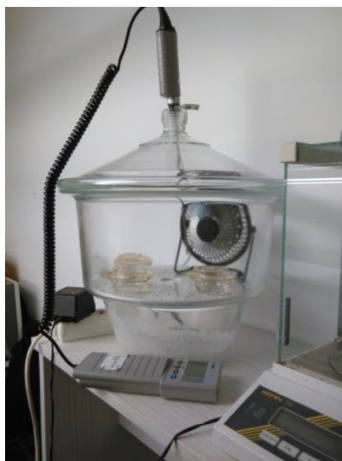
Figura 12- Exsicador com células de permeabilidade
